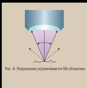
Рис. А: Разрешение ограничивается NA объектива
