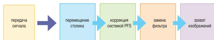
Как только поступает команда от ПК, контроллер Ti берет на себя управление моторизованными компонентами. При этом сокращается время работы за счет сокращения времени передачи сигнала непосредственно между ПК и моторизованными компонентами.
