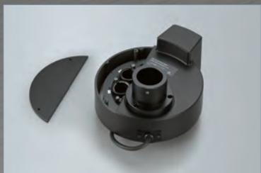
Можно производить смену положений запирающего фильтра (8 положений при использовании 25 мм фильтров) с высокой скоростью, за 0,15 с на смену одного положения.
