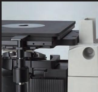
Основание столика для конфигурации микроскопа без диакопического осветителя
