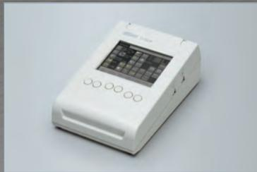
Состояние микроскопа можно выбрать при помощи иконок. Управление микроскопом можно осуществлять через сенсорную панель.
