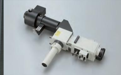
Возможны моторизованное управление углом падения луча и изменению положения с помощью сохраненных в памяти установок
